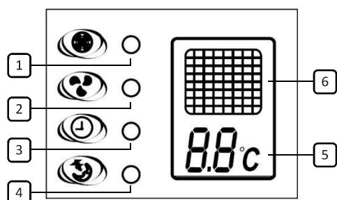
1. Кнопка включение/выключение автоматического режима
