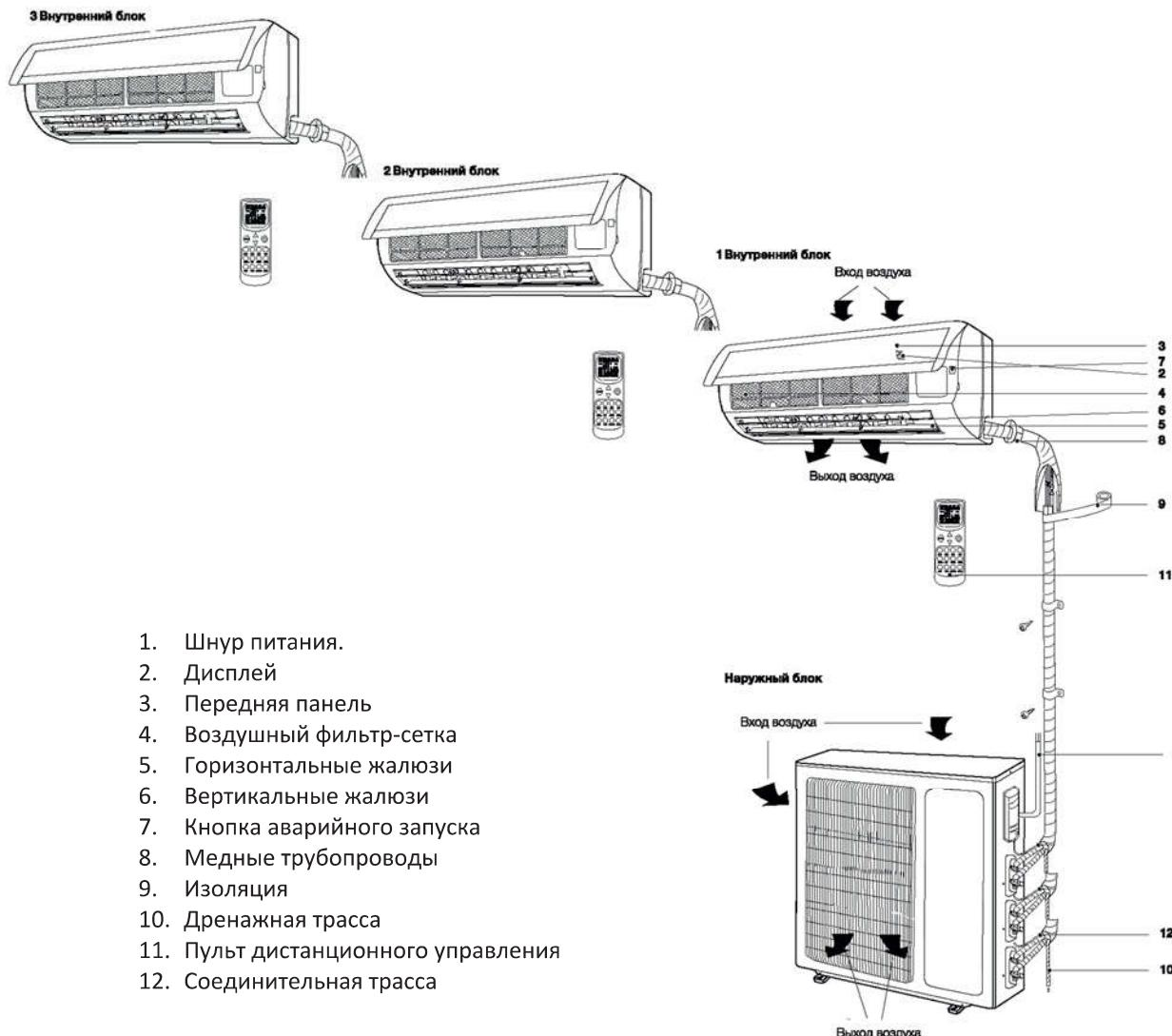
\* Внешний вид блоков Вашего кондиционера может отличаться от схематичных изображений в инструкции.
