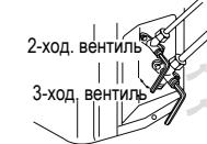
7. Для предотвращения утечек затяните колпачки сервисного порта и штоков жидкостного и газового стопорного вентилей, контролируя прилагаемое усилие затяжки. Затяжку рекомендуется производить чуть дольше, чем потребуется резкое увеличение усилия затяжки (крутящего момента).
