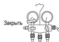
4. Для подачи хладагента в контур откройте 2-ходовой жидкостной стопорный вентиль, повернув шток вентиля на  $90^\circ$  против часовой стрелки. Через 6 сек. закройте вентиль и проведите проверку контура на утечки.
