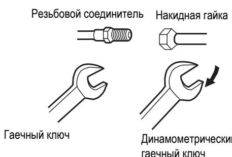
Чрезмерное усилие затяжки при отсутствии центровки может привести к повреждению резьбы и утечкам хладагента.
