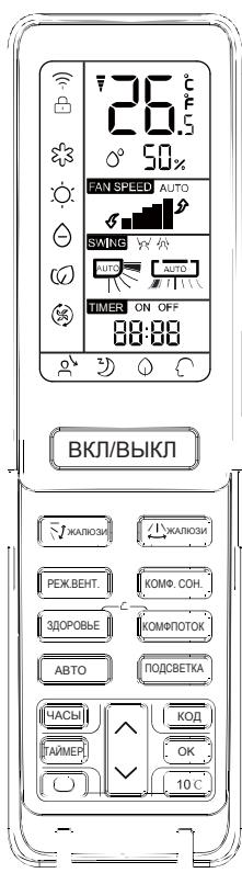
Режим вентиляции: по умолчанию низкая скорость вентилятора, температурная уставка не отображается, температура на дисплее ВБ - 24 °C.
