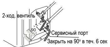
5. Проверьте на утечки плотность всех соединений. При обнаружении утечки перезатяните соединение заново. После этого, если утечка устранена, переходите к действиям п. 6. Если утечка не устранена, эвакуируйте хладагент из контура через сервисный порт. Повторно выполните вальцованные соединения межблочных линий, вакуумирование и проверку контура на утечки газа, а затем заправьте систему требуемым количеством хладагента.
