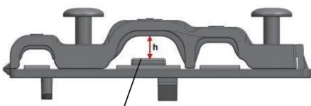
Если кабель не закреплен достаточноочно прочно, используйте фиксатор, чтобы поднять провод и зажать его плотно.
