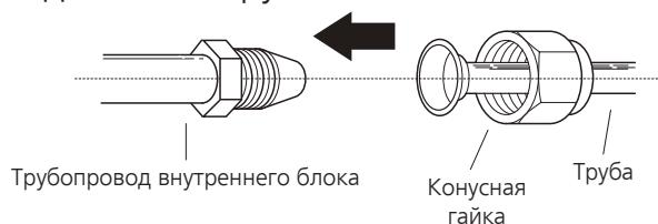
2. Затяните конусную гайку вручную до упора.
