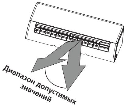
**ПРИМЕЧАНИЕ:** Не перемещайте жалюзи вручную. Это может сделать их автоматическое перемещение несинхронным. Если это произойдет, выключите кондиционер и извлеките вилку кабеля питания из розетки на несколько секунд. При последующем включении питания нормальное функционирование жалюзи будет восстановлено.
