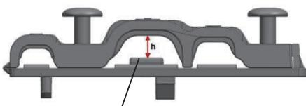
Если кабель не закреплен достаточноочно прочно, используйте фиксатор, чтобы поднять провод и зажать его плотно.
