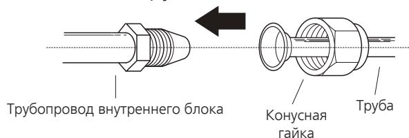
2. Затяните конусную гайку вручную до упора.
