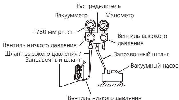
6. Закройте вентиль низкого давления распределителя и выключите вакуумный насос.
