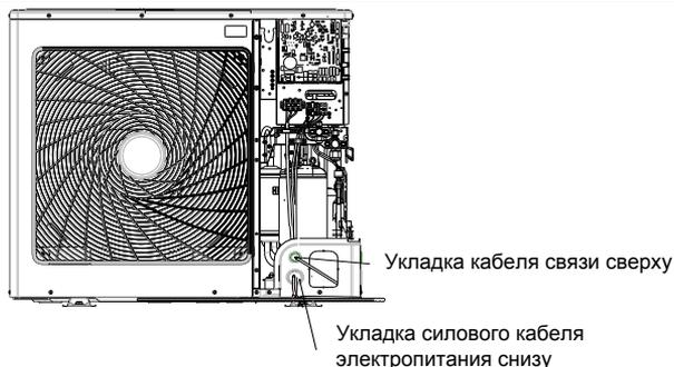
Силовая линия электропитания должна быть проложена вдоль правой боковой панели и крепиться к опорам с помощью пластиковых хомутов, не касаясь трубопроводов для хладагента. Линия связи между внутренним и наружным блоками также должна быть проложена вдоль правой панели на безопасном расстоянии от силовой линии электропитания.
