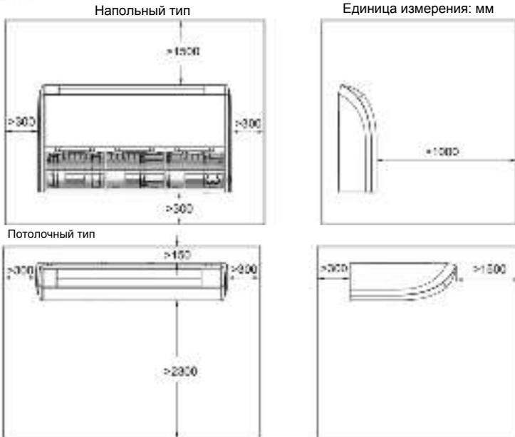
4) Агрегат должен быть установлен в месте, обеспечивающем легкий доступ к подключению дренажа, и надежный отвод конденсата по дренажному трубопроводу.
