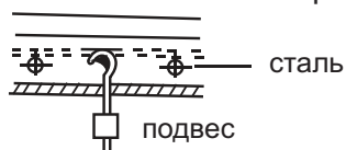
(подвес трубопровода или блока)
