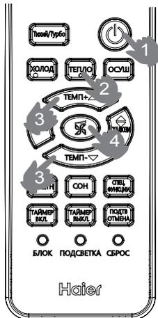
1. Для включения кондиционера нажмите кнопку ON/OFF, кондиционер включится в работу согласно последнему выбранному режиму.
