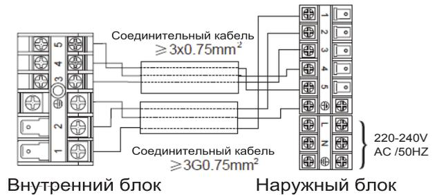
Для инверторных моделей используется кабель управления 4x1,5 мм<sup>2</sup>:
