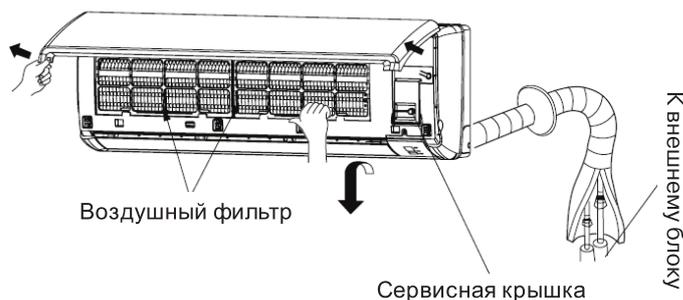
4. Пропустите провода межблочных соединений от наружного блока через отверстие в задней части корпуса внутреннего блока. Выведите их с лицевой стороны, предварительно открутив сервисную крышку.
