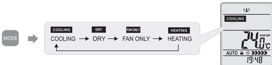
**i** Переключение между режимами кондиционера занимает определенное время. При включении кондиционера на режим обогрева, кондиционер тратит от 2 до 5 минут на разогрев теплообменника, после чего подует теплый воздух.
