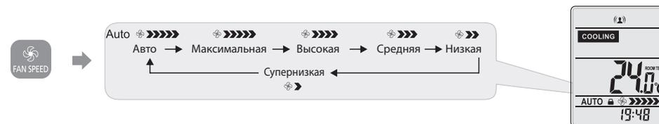
**i** В режиме FAN, режим AUTO (автоматический выбор скорости вентилятора) не доступен. В режиме DRY скорость вращения вентилятора устанавливается автоматически, и кнопка FAN SPEED не используется.
