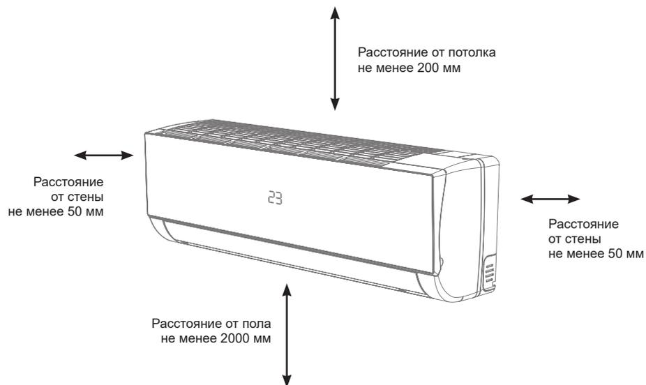
**i** Поверхность стены, на которой устанавливается внутренний блок, должна быть гладкой и ровной, конструкция стены должна выдерживать нагрузку не менее 60 кг.
