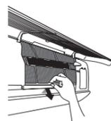
**4** Вымойте большой фильтр (фильтры) мыльной водой. Прополощите в чистой воде. Встряхните фильтр для удаления излишков воды.
