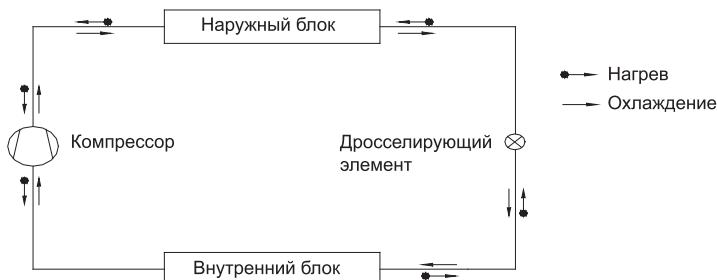
Рисунок 4.2 – Схема работы кондиционера
