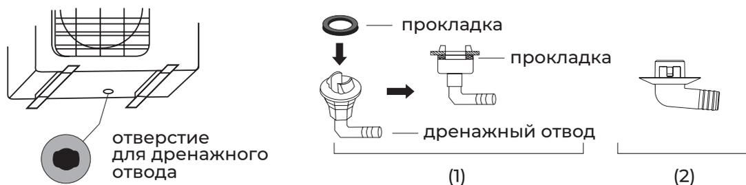
**Примечание:** изображение конструкции дренажного патрубка приведено для справки. Конструкция дренажного патрубка вашего кондиционера может отличаться (например, может отсутствовать резиновая прокладка).
