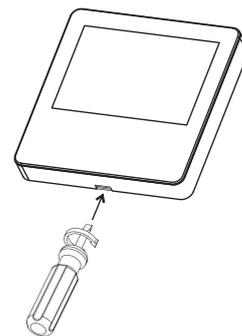
**Примечание:** Плата управления проводного пульта соединена с передней частью пульта. При отсоединении задней крышки, будьте аккуратны, чтобы не повредить плату управления.
