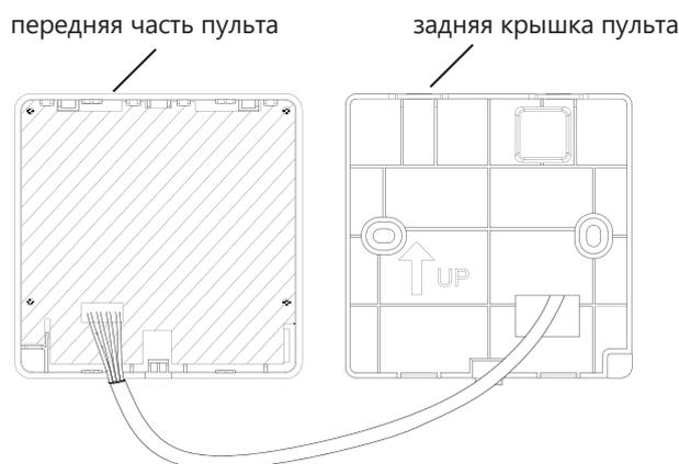
**Примечание:** Соединительный кабель должен быть надежно зафиксирован после подключения. Для исключения попадания жидкости или насекомых внутрь пульта, все отверстия должны быть заизолированы с помощью специальной замазки или иных материалов.
