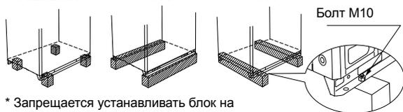
\* Запрещается устанавливать блок на четырех угловых опорах.
