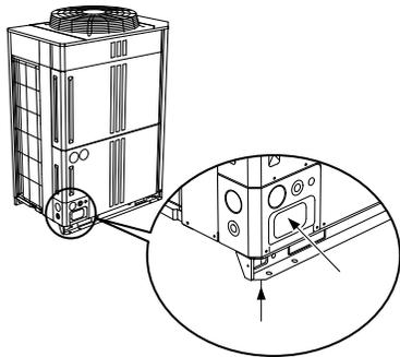
**Рис. В** Габариты выбиваемого отверстия на нижней панели
