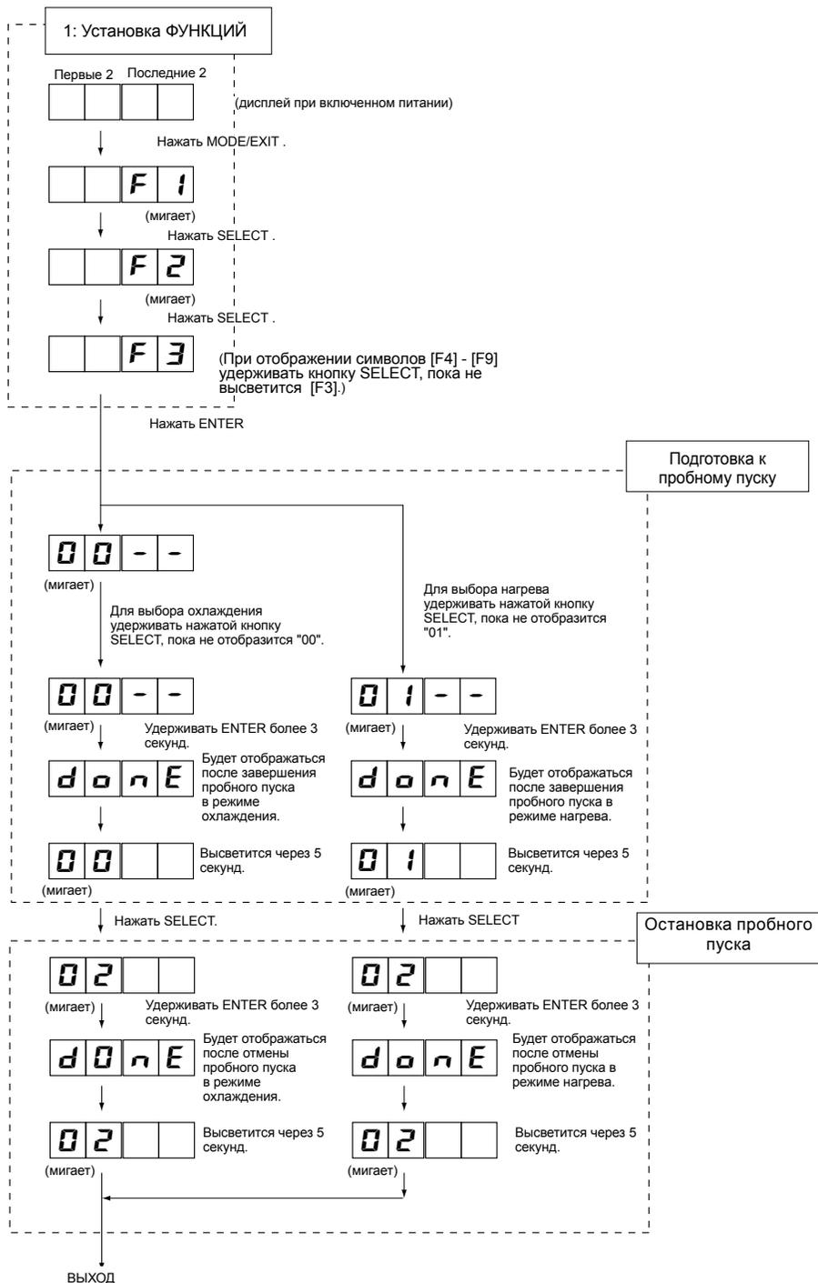
После завершения режима тестирования питание следует отключить. Присоединить крышку электрической секции и лицевую панель наружного блока.
