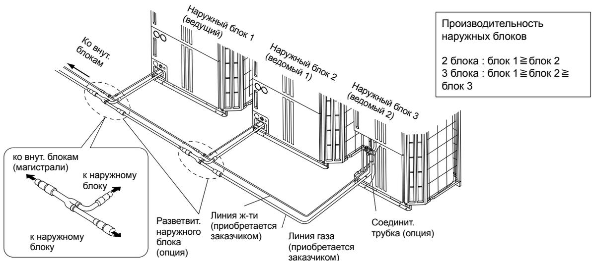
**Рис. примеры монтажа нескольких наружных блоков**
