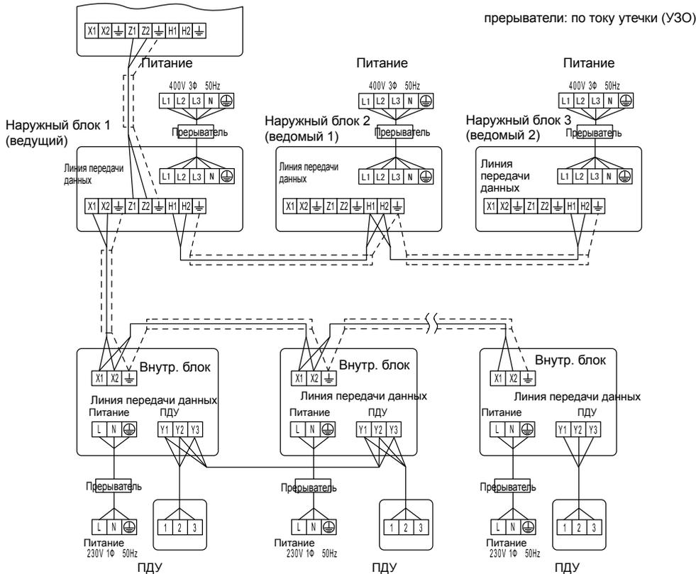
Пример подключения проводов к наружным и внутренним блокам приводится на рисунке. Открыть крышку электрической секции и подключить провода к клеммной колодке. Затем зафиксировать из зажимом. При подключении проводов не следует прилагать излишних усилий.
