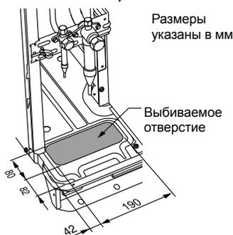
**Рис. С** Габариты выбиваемого отверстия с лицевой стороны
