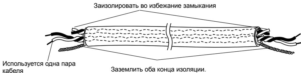
Если используется линия передачи данных с двумя парами жил, то используется только одна из них.
