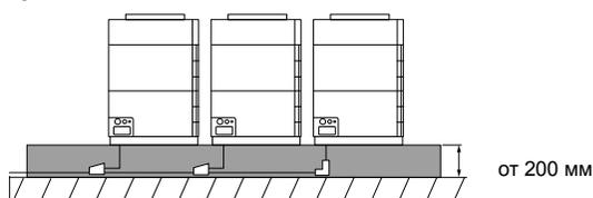
В случае проводки трубных линий под основаниями наружных блоков, высота свободного пространства должна составлять от 200 мм.
