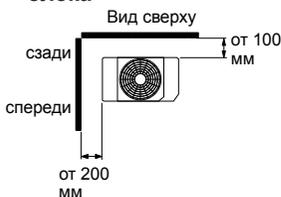
Рис. 9 Монтаж нескольких блоков
