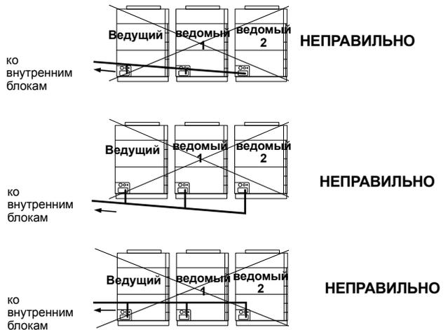
(1) Если длина трубной линии между двумя разветвителями наружных блоков или разветвителем наружного блока и ведомым блоком превышает 2 м, то необходимо установить на линии газа маслоотъемные петли во избежание дальнейшего переноса масла и его невозврата, которые могут привести к аварийному останова наружного блока.
