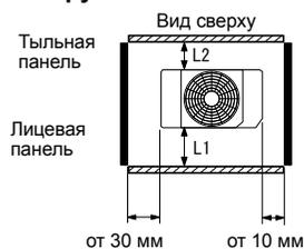
**Рис. 3 Установка нескольких наружных блоков**
