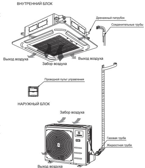
**Наружный блок:** корпус, теплообменник, электромотор, вентилятор, компрессор, электронные компоненты.
