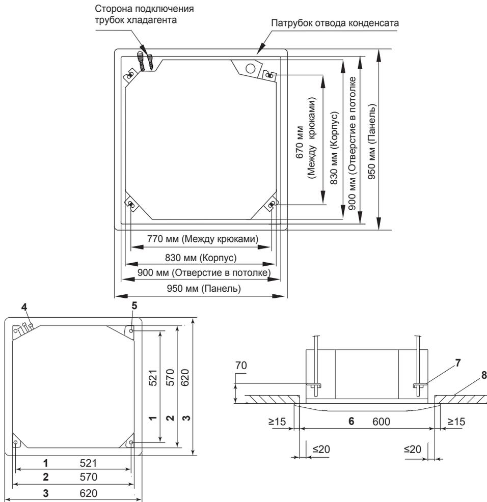
1 — петли крепления внутреннего блока; 2 — размеры внутреннего блока; 3 — размеры панели внутреннего блока; 4 — трубопроводы; 5 — петли крепления (×4); 6 — отверстие в потолке; 7 — шпильки в ушах крепления внутреннего блока; 8 — фальш-потолок
