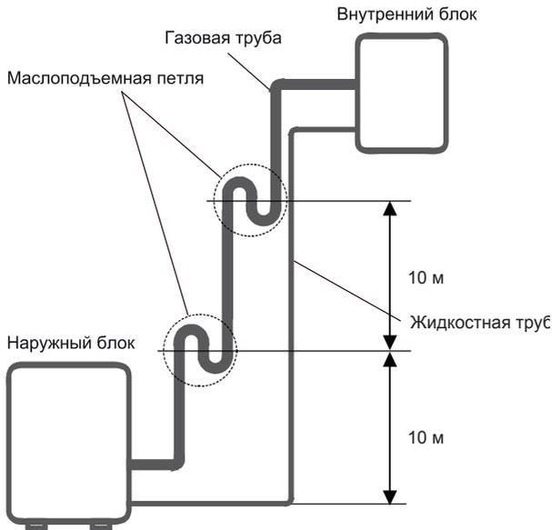
**Если наружного блок установлен выше внутреннего блока:**
