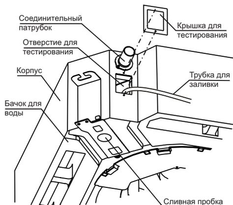
4. Включите питание и запустите кондиционер в режиме охлаждения. Прислушайтесь к звуку от дренажной трубы. Убедитесь в том, что вода сливается (учитывая длину дренажной трубы, вода может появиться с задержкой примерно на 1 минуту), проверьте герметичность соединений.
