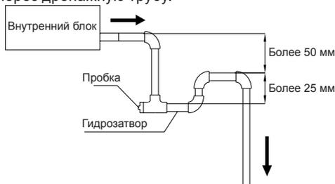
4. При подключении нескольких кондиционеров к одной дренажной системе, установите трубы, как показано на следующем рисунке.
