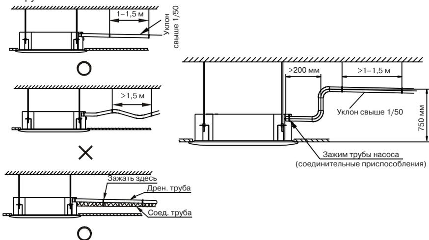
2. Накройте трубопровод теплоизоляцией, чтобы предотвратить конденсацию и утечку.
