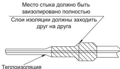
Теплоизоляцию закрепите монтажным скотчем.
