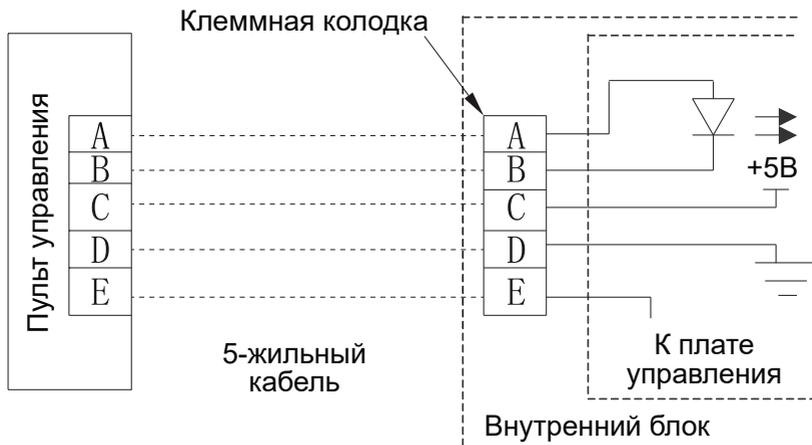
Подсоедините провод от панели дисплея внутреннего блока к соединительному кабелю. Затем подсоедините другую сторону соединительного кабеля к пульту дистанционного управления.
