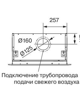
Подключение трубопровода подачи свежего воздуха
